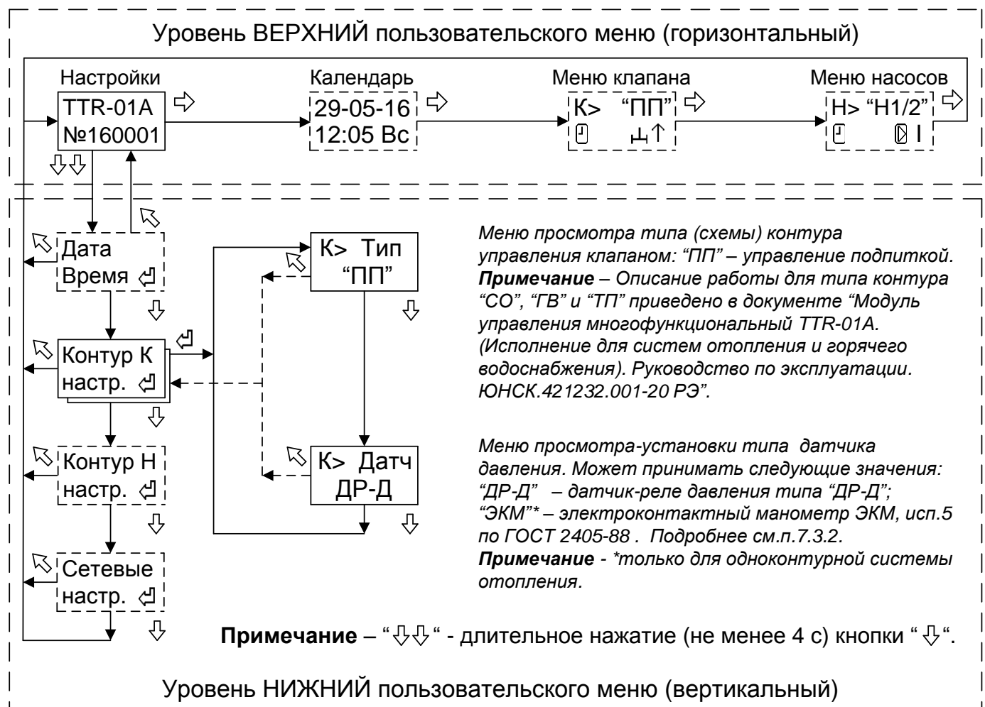
Рисунок 4 - Структура меню настройки параметров контура управления клапаном подпитки
