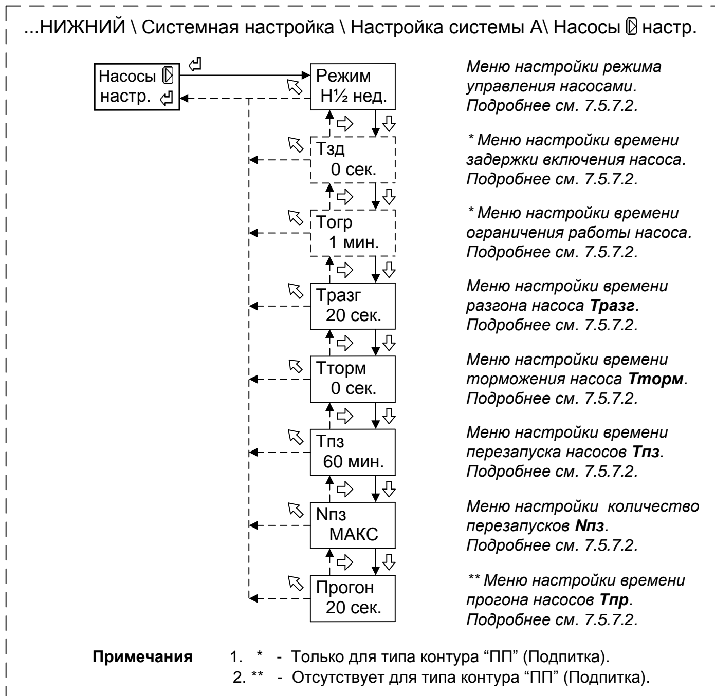
Рисунок 20 - Структура меню настройки параметров управления насосов
