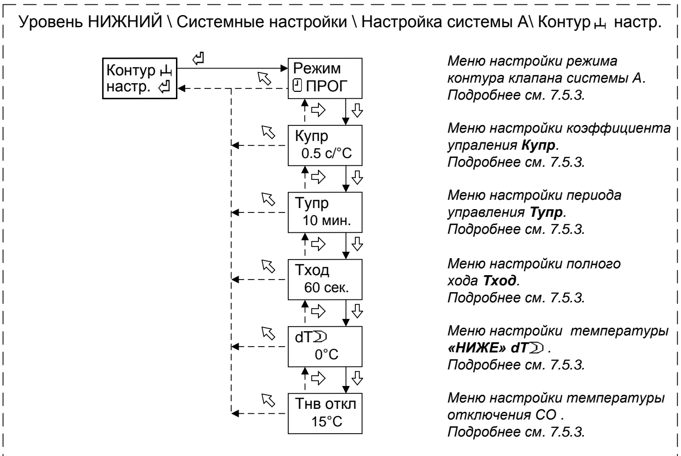
Рисунок 13 - Структура меню настройки параметров контура “СО”
