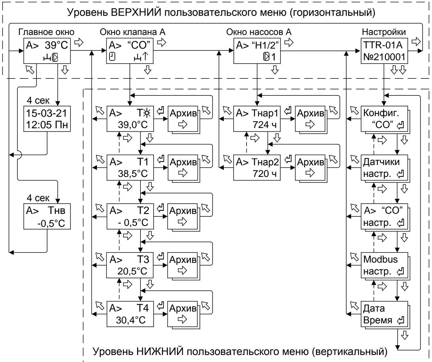
Рисунок 3 – Общая структура меню для конфигурации "СО" или "ГВ"
