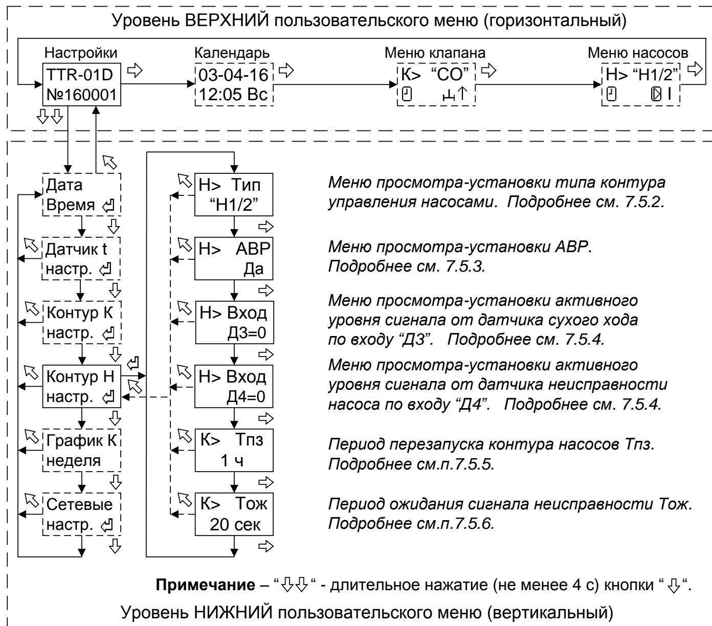
Рисунок 9 - Структура меню настройки параметров контура управления насосами.
