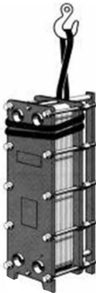
Строповка теплообменника без транспортировочных отверстий
