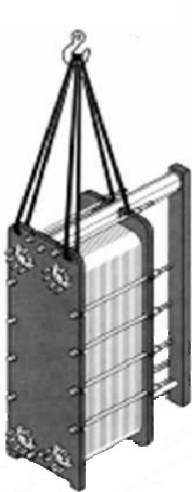
Строповка теплообменника с транспортировочными отверстиями
